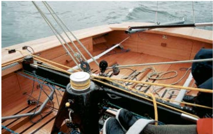
**Die meisten Streckler laufen am Kohlefasertraveller zusammen. Die Genuawinch in der Mitte wird über Leinen, die auf die Seitendecks laufen, bedient**
